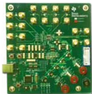
CDCM6208V1EVM: 8出力クロックジェネレータの評価モジュール
