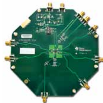
LMK00105BEVAL : 5出力ファンアウト・バッファ/ レベル・トランスレータの評価モジュール
